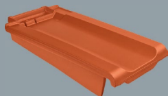
Dachówka szczytowa lewa Waga: ok. 5,1 kg Szer. krycia: 28,3 cm Dł. krycia: 36,2 - 38,0 cm Paleta: 44 szt.
